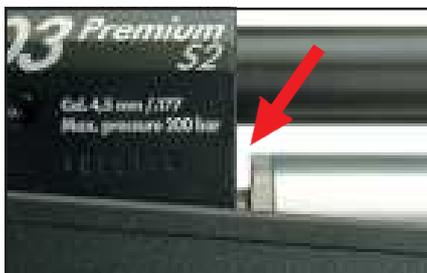
Kurz vor dem Anschlag ist ein deutlicher Widerstand spürbar, das Kartuschenventil öffnet sich dabei automatisch.
