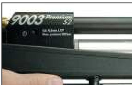
Vorgang 2-3 Mal wiederholen, damit die Luft entweichen kann, die sich noch im Gewehr befindet. Die Kartusche kann somit ohne Druck auf den O-Ring ausgeschraubt werden.
